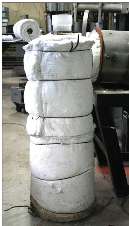
Изолirana с минерална вата пещ за израстване на кристали, използвана в Лабораторията.
