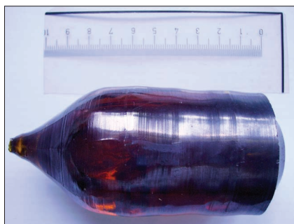
Кристал от \text{Bi}_{12}\text{SiO}_{20} , получен в Лабораторията по метода на Чохралски.
