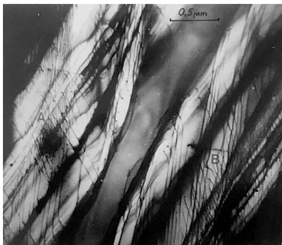
Фигура 4. Зони на образуване на дислокационни системи, означени с А и В, E=65\text{ kV} .
