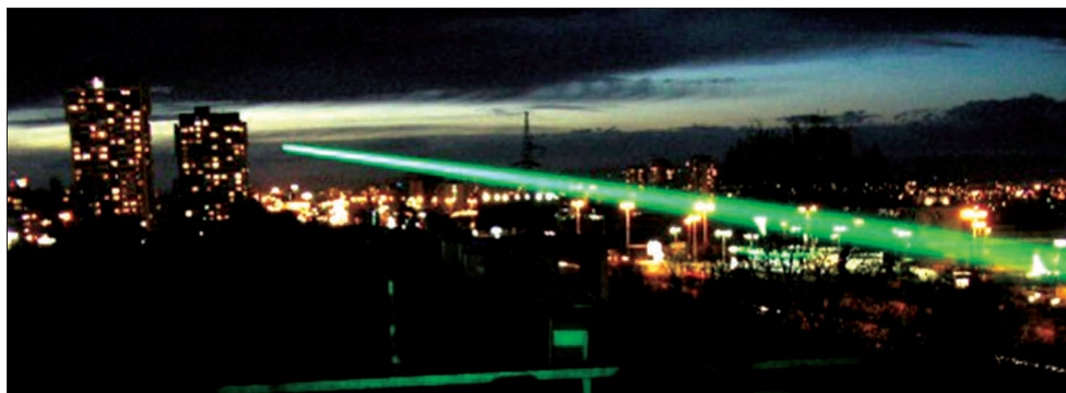
Фигура 3. Лазер с пари на меден бромид със средна мощност 40 W и време на живот над 500 часа осветява небето над гр. София по случай Годината на светлината 2005.
