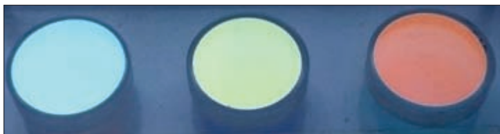
Фигура 2. Многослойни тесноивични интерференчни филтри за дължини на вълната 488 nm (син), 512 nm (зелен) и 633 nm (червен).
