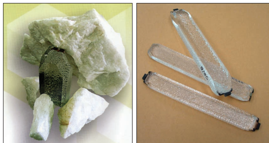
Пиезоелектрични кварцови кристали, синтезирани от българска суровина в лаборатория „Акустоелектроника“, 1981 г.
