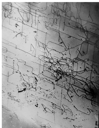
Фигура 5. Сплитания и зони с висока концентрация на точкови дефекти, означени със стрелки, E=1\text{ MV} .
