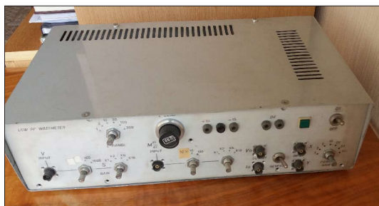
Електронен ватметър за изследване на променливо-токовите загуби на енергия в свръхпроводниците.
